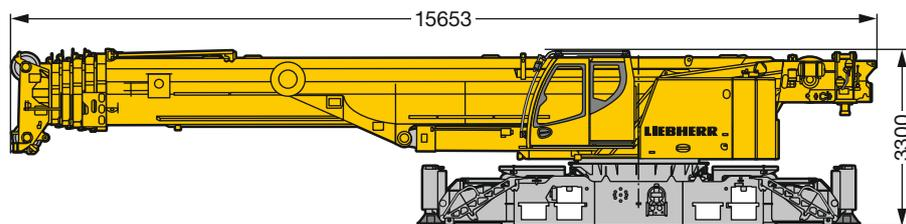
Grundgerät, Breite 3000 mm, **ohne** Jack-Up Zylinder, **ohne** Querträger
