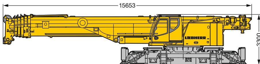
Grundgerät, Breite 3000 mm, mit Jack-Up Zylinder, **ohne** Querträger
