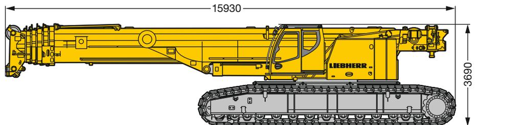
Grundgerät, Breite 3000 mm, mit Jack-Up Zylinder und Querträger
